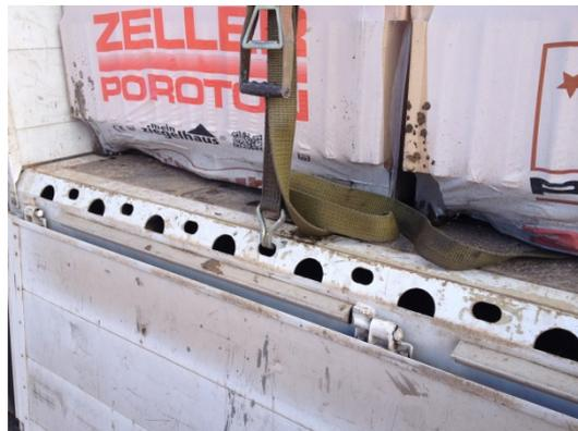
3. Kantenschutzprofile angebracht
