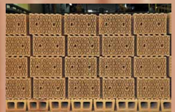
Auf rollenden Wagen verlassen die heißen Ziegel den Brennofen.
