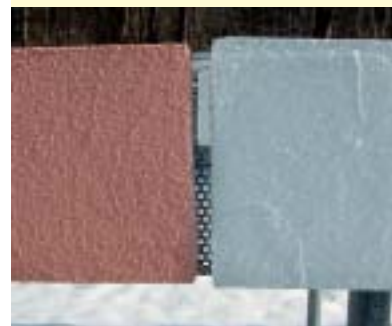
Unterschiedliche Aufheizung/Austrocknung bei verschiedenen Farbönen
