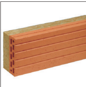
Deckenrandschale mit werksseitig aufgeklebter Isolierung, einer speziellen, hydrophobierten Mineralwolle (WLG: 035), gegen Schalungsdruck.
