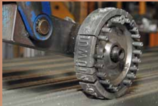
Jede Produktionscharge wird mit diesem Rollstempel gekennzeichnet.
