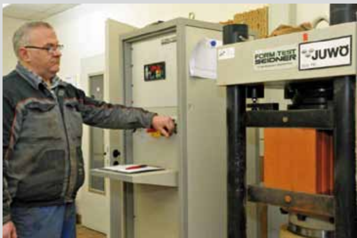
Ziegel-Belastungstest im werkseigenen Labor
